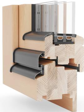
Die Variante des Profils, die den Einbau neuer Fenster in bestehende Gebäude ermöglicht, ohne dass die alten Holzrahmen entfernt werden müssen. Es besteht die Möglichkeit, verschiedene Längen von Renovierungslossen zur Abdeckung des alten Rahmens im Inneren des Gebäudes zu verwenden.
