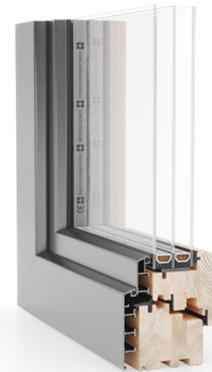
Das Profil mit RenoLine/Gemini Classic-Aluschalen verändert vollkommen die Außensicht der Fenster und erhöht gleichzeitig die Langlebigkeit durch einen zusätzlichen Witterungsschutz des Holzes.
