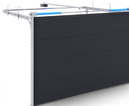
Die Torsionsfedern sind für Tore unterschiedlicher Größe bestimmt. Sie können wesentlich mehr Gewicht als Zugfedern heben. Anschraubung der Federn, die für 25.000 Zyklen ausgerichtet sind. Der Einbau ist möglich, wenn die Sturzhöhe mindestens 200 mm beträgt. Das maximale Torgewicht beträgt bis zu 295 kg.
