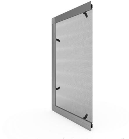
Das Moskitonetz ist für den Einbau in Kunststofffenster konzipiert und ist in holzähnlichen Farben erhältlich. Es ist möglich, die Profile in einem 90°-Winkel mit der Kunststoffecke oder in einem 45°-Winkel mit der Innenecke zu verbinden. Dies sind die einzigen Moskitonetze, die an Modellfenster angeschlossen werden können.
