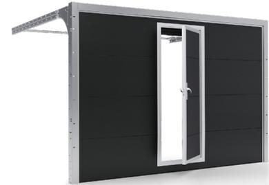
Die Durchgangshöhe kann 1720 bis 2000 mm betragen, sie ist von der Höhe der gewählten Paneele abhängig und wird in der Produktionsphase individuell angepasst Die Beschläge in Türen werden standardmäßig aus eloxiertem Aluminium gefertigt, wodurch seine Korrosionsbeständigkeit erhöht wird
