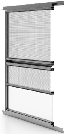
Das Schiebeyesystem verwendet einen Mechanismus aus parallelen Führungen im oberen und unteren Teil des Rahmens. Diese Lösung ist für die Schiebeyesysteme HST und PSK geeignet. Möglichkeit der Verwendung von speziellen Gittern und Trittplatten. Möglichkeit der Doppelverschiebung für große Spannweiten.
