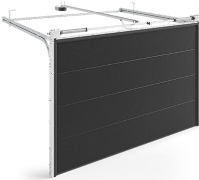
INFINITI Thermo F und R - Paneele sind 60 mm dick und erreichen einen der besten Wärme-Koeffizienten auf dem Markt. Dieser Schutz wird auch durch doppellippige Dichtungen mit einer Wärmekammer gewährleistet. Die Federn sind für 25.000 Zyklen ausgelegt..
