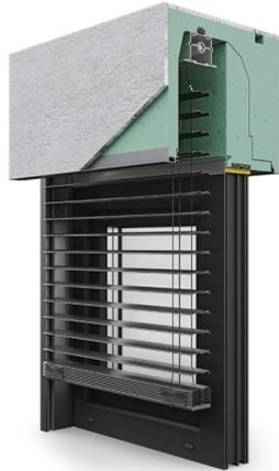
Die Kombination von Neopor®/Styropor® mit einer dichten Konstruktion ergibt einen hervorragenden Schutz vor Sonne, Wind und Feuchtigkeit. Durch zusätzliche Verstärkungen, wie im Schaum eingebettete Stabilisierungskonsolen, Fensteraussteifungen und innovative Befestigungen, wird eine mit Fenster und Wand dauerhaft verbundene Konstruktion geschaffen
