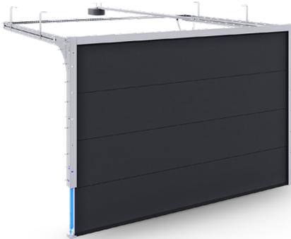
Die Zugfedern werden für den Einbau in Garagen mit kleinen Torflächen empfohlen. Die Montage erfolgt schnell und erfordert keine spezielle Anschraubung der Federn, die für 15.000 Zyklen ausgerichtet sind. Dabei wird ein doppelter Federmechanismus (die sogenannte "Feder in der Feder") verwendet, der ein Panzergewicht bis zu ca. 130 kg ermöglicht.
