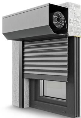
System mit einem spezifischen, von der Außenseite 45 Grad abgeschägten Kasten. Eine ausgezeichnete Lösung für jene, die Ausfertigungselemente mit scharfen, geometrischen Formen bevorzugen. Durch die universelle Kastenform eignet sich der Rollladen zur direkten Fassadenmontage sowie zur Befestigung an der Fensterzarge.
